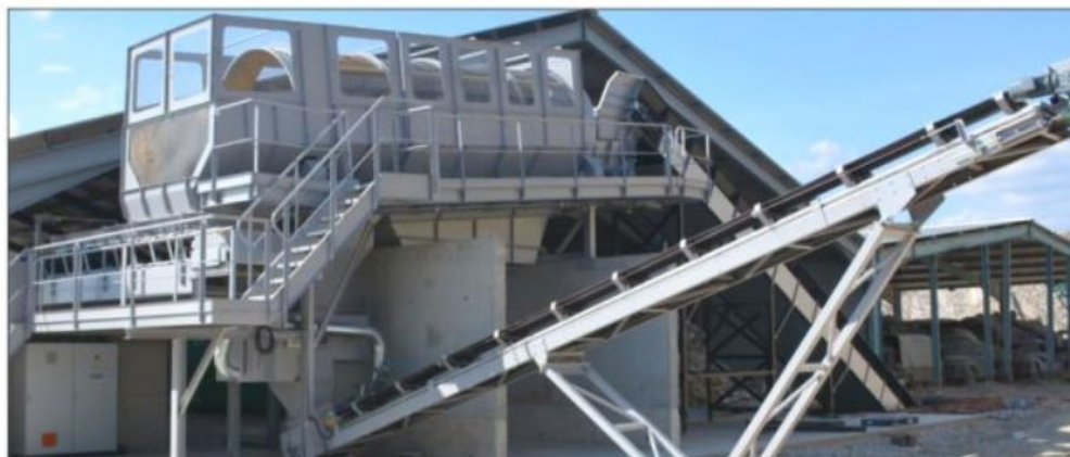
Cette machine permet de trier jusqu'à 90 % des déchets non dangereux grâce à un système sophistiqué de criblage, d'évacuation et de stockage.
