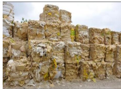
Après triage et compactage, des balles de laine de verre prêtes au réemploi...
