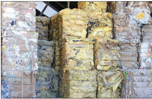
Comme d'autres déchets, la laine de verre passe sous des presses, puis est transformée en balles prêtes à la valorisation dans des usines de production. Une filière de recyclage quasi infinie.
